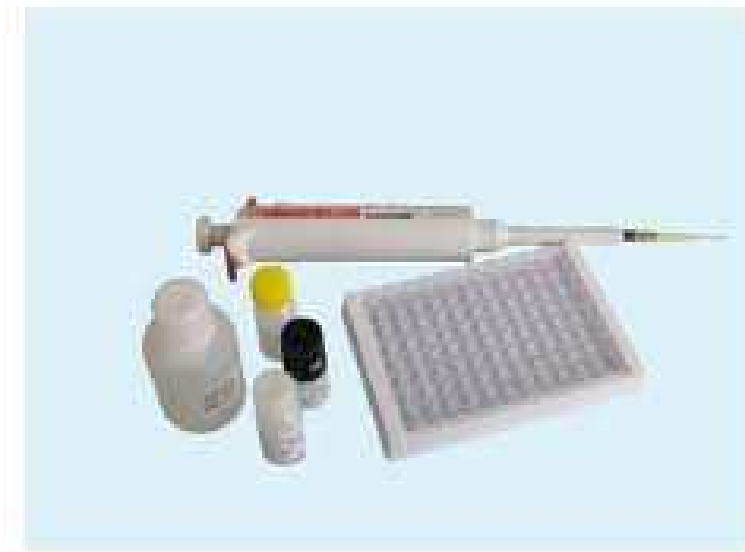
Figura 7. Formato commerciale con micropiastra a 96 pozzetti di un Kit ELISA
